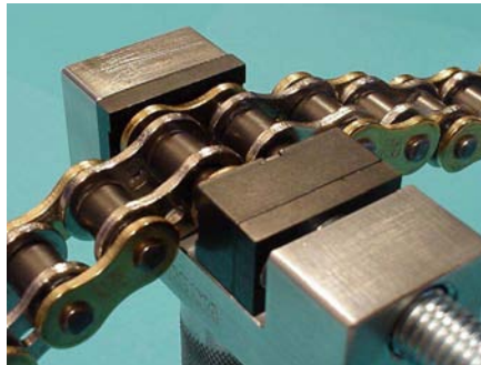
ENUMA Kettenlaschenzentrierwerkzeug zum gleichmäßigen Aufpressen der Laschen (nicht zum Vernieten geeignet!)
