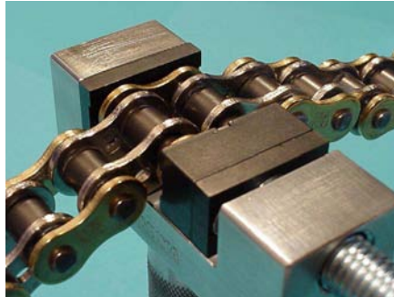
ENUMA Kettenlaschenzentrierwerkzeug zum gleichmäßigen Aufpressen der Laschen (nicht zum Vernieten geeignet!)
